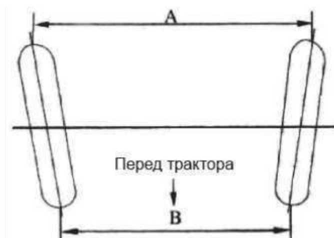
Рис. 3.22. Развал-схождение. Трактор. Вид сверху.
